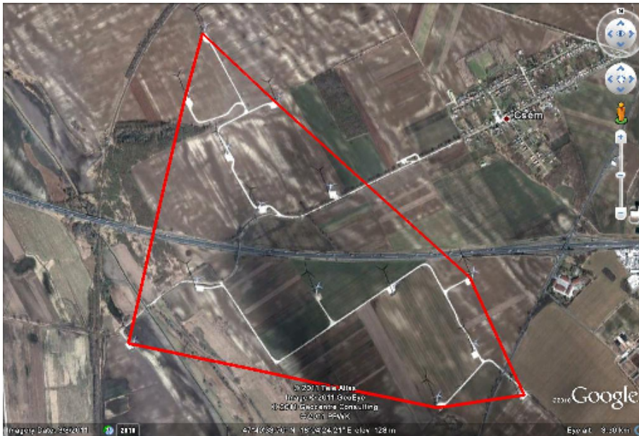
Slika 1. Raspored vjetroagregata u vjetroparku u Mađarskoj. Udaljenost između dva najbliža vjetroagregata je manja od 350 metara.
